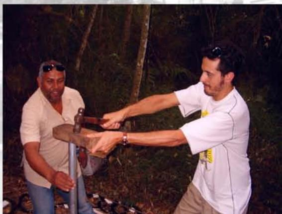
Fixação da haste da caixa do datalogger.
