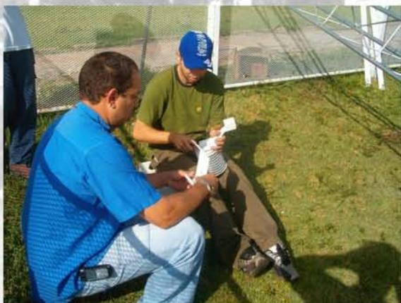
Montagem do abrigo do termômetro.
