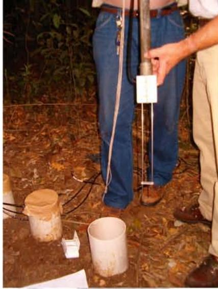
Inserção de sensores de umidade de solo.
