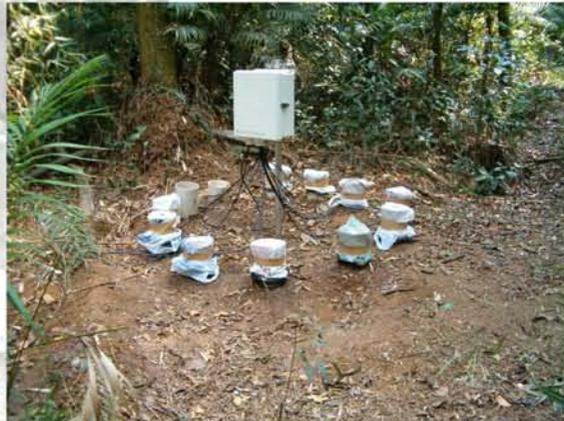
Rede de sensores de umidade de solo.
