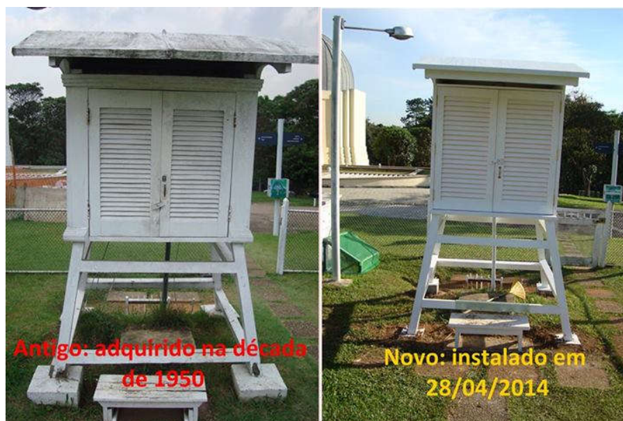
Figura 1 – Comparação entre o abrigo antigo e o novo abrigo, instalado em 28 de Abril de 2014 13
