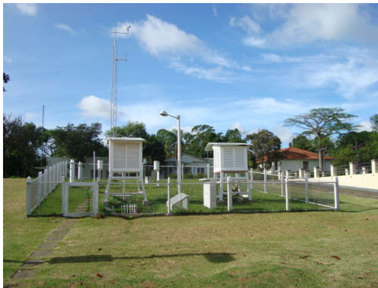
Figura 4 – Cercado Meteorológico já ampliado, com o abrigo meteorológico reserva (à direita) já colocado. À esquerda, o abrigo meteorológico novo, conforme indicado na Figura 1 e Figura 3. Imagem de 29 de Janeiro de 2015.
