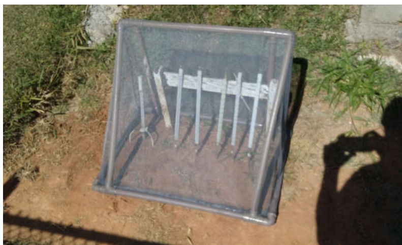
Figura 1 – Foto ilustrando o sistema de proteção dos termômetros de solo cobrindo os mesmos. Foto de Edvaldo Gomes.
