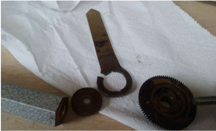
Figura 2 - Alavanca do pluviógrafo que estava danificada.
