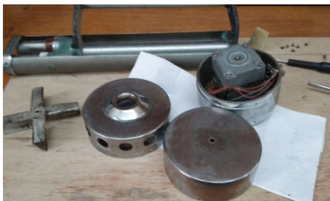
Figura 5 - Psicrômetro desmontado, para limpeza e polimento.
