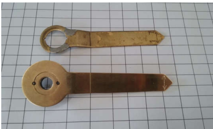
Figura 4 - Peça nova (parte inferior da foto) feita pelo LIME em comparação com a peça original, que tinha sido provisoriamente reparada na EM-IAG-USP. Na confecção da peça nova houve a preocupação de alargar o anel, para garantir maior resistência.
