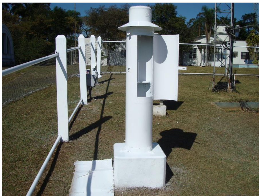
Figura 2 - Pluviógrafo Hellmann e sua estrutura repintada na cor branca, além dos mourões do cercado meteorológico. Foto de 07 de julho de 2017.
